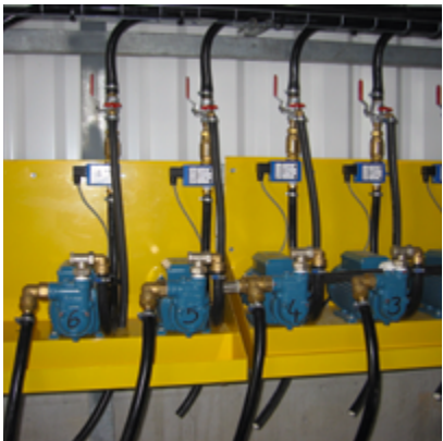
Pompes doseuses à adjuvants Comptage par débitmètre électromécanique ou volucompteur
